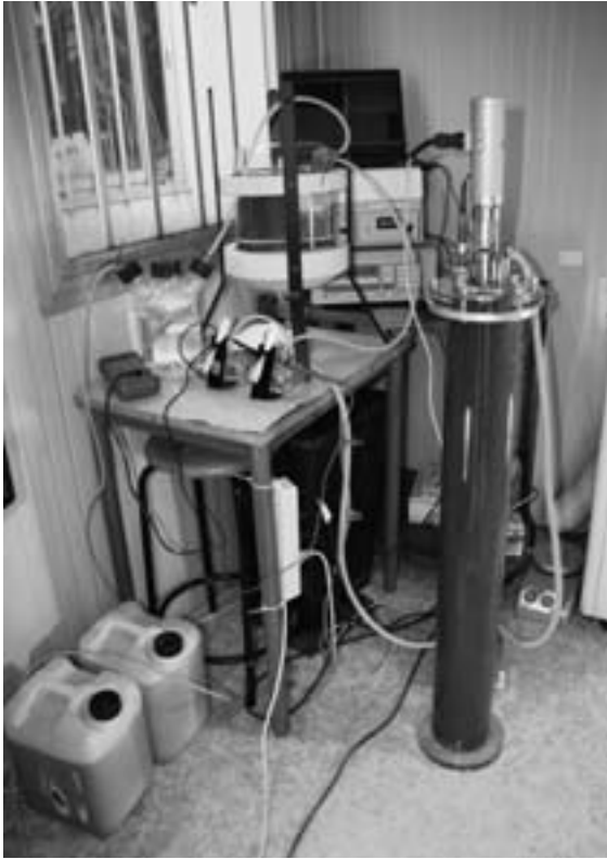
Figura 3. Fotobioreattore utilizzato per la produzione di idrogeno con batteri fotosintetici rossi non sulfurei in coltura su fermentato da residui vegetali (De Philippis et al., 2007).
