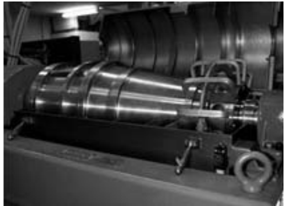
Figura 1. Decanter di prima generazione, con lungo cono di spiaggiatura e cilindro di piccole dimensioni.
